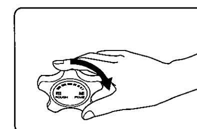
1 刃物調節ツマミを右に一杯回して氷削台上面より刃物を下げてください。下がっていないと、刃物でケガをすることがあります。
