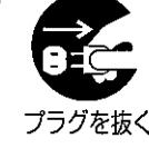
切削室内の掃除や点検・刃物交換のときは必ず電源スイッチをOFF(切)にして電源プラグを抜き、手袋をはめておこない、刃先に直接手を触れないこと
