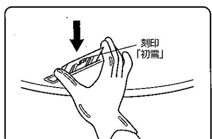
7 新しい刃物の刻印「初雪」がガイドプレート側になるようにして、氷削台の上からブレードホルダーとガイドプレートの間に差込んでください。
