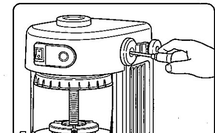
3 付属の取り付けネジを上下ハンドルに通して#ドライバーで締付け、上下ハンドルを回して主軸が上下することを確認してください。
