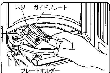
5 刃物固定ネジ(2本)を $\oplus$ ドライバーで少しゆるめてください。この時ネジは完全に取り外さないでください。
