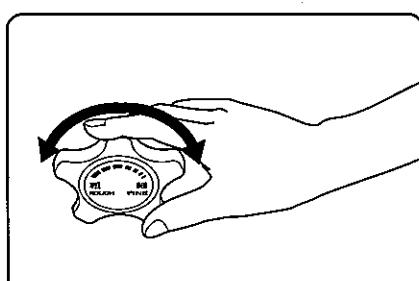
9 刃物調節ツマミを左右に回して、好みの粗さに調節してください。
