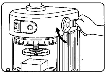
1 電源スイッチをOFF(切)にし、上下ハンドルを時計方向に回して氷押えを上げます。
