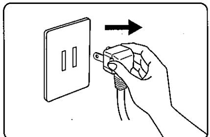
1 電源スイッチをOFF(切)にして、コンセントから電源プラグを抜いてください。
